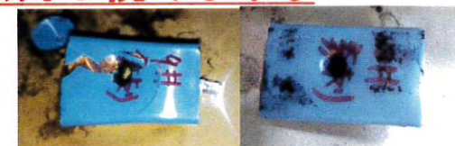
強い衝撃による亀裂や貫通穴
